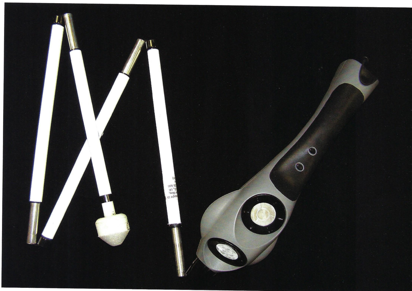
Ultracane et détection longue portée par ultrasons.
